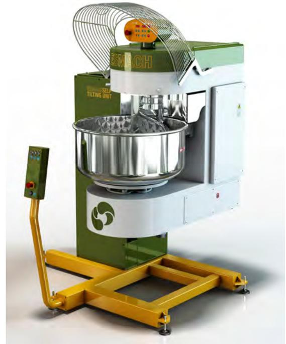
TSPI è un'impastatrice auto-rovesciante di tipo compatto, composta da un'impastatrice a spirale SPI stabilmente accoppiata ad un sollevatore oleodinamico, predisposto per alzarne verticalmente l'intera struttura e, con un movimento di rotazione, rovesciare l'impasto contenuto nella vasca sul sottostante banco di lavoro, oppure all'interno dell'appropriata tramoggia di spezzatrici volumetriche, a destra o a sinistra, a seconda del modello prescelto.
